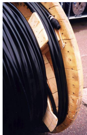
Primer kabla v rezervi navitega na bobnu z daljšim notranjim koncem.
