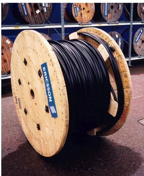
Primer kabla v rezervi navitega na bobnu z daljšim notranjim koncem.
